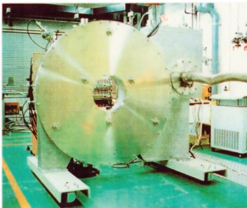
**Fig. 6** Cryogen-Free R&D Magnet
