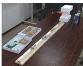
演示実験に使われた 4 段式ガウス加速器と 演示実験の様子
