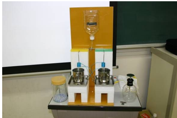
図5 これがケルビン静電発電機の完成版です。
