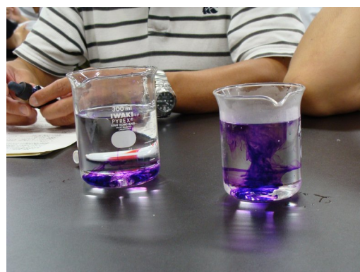
図2 インクの拡散実験 (右側が温度の高い水)。
