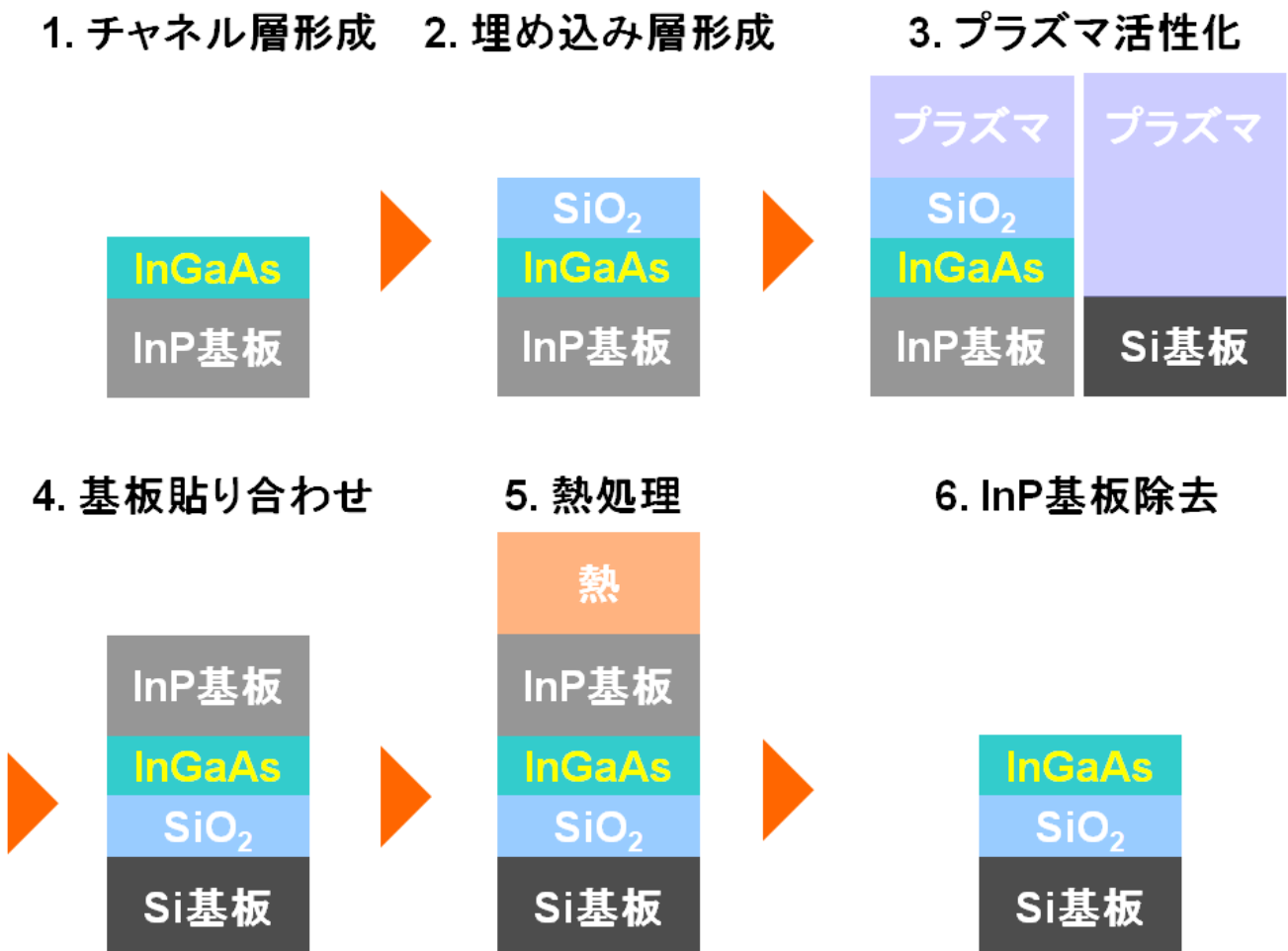
図 A-1 開発した直接基板貼り合わせ技術の概念図。
