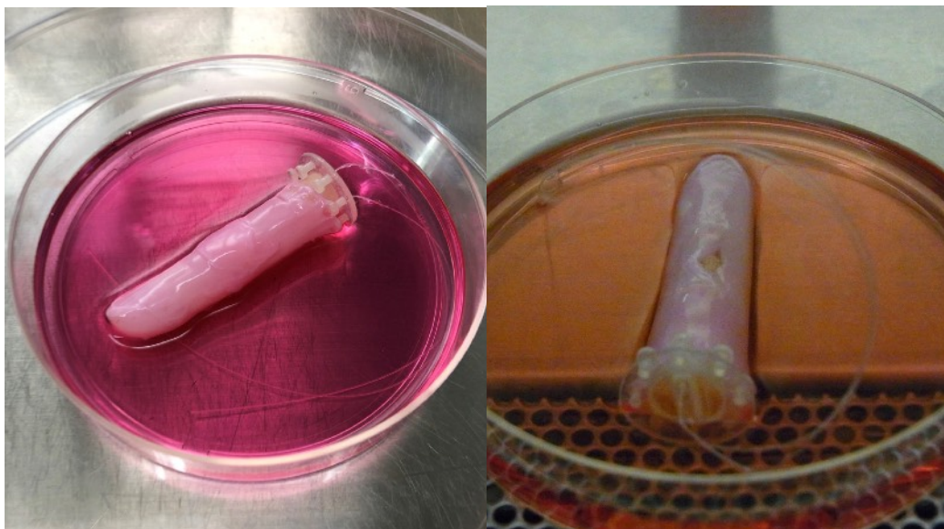
図1: 左:培養皮膚を用いた指型ロボット 右: 傷を自己修復している様子
