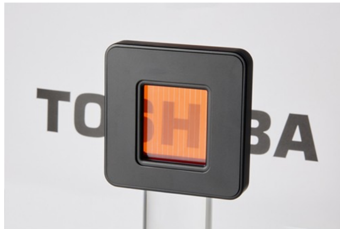
図2 試作された40mm角の透過型Cu 2 O太陽電池セル（東芝 提供）
