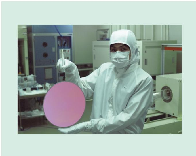
Fig.12 300mm-diameter ELTRAN<sup>®</sup> Wafer.
