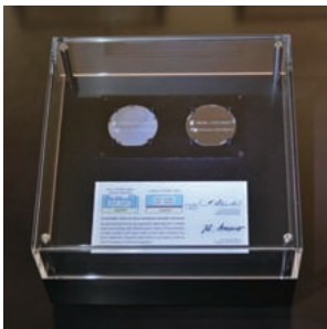
赤崎先生が寄贈した低温バッファ層を用いて(右側)、低温バッファ層を用いずに(左側)サファイア上に作製したGaNウェーハ。
