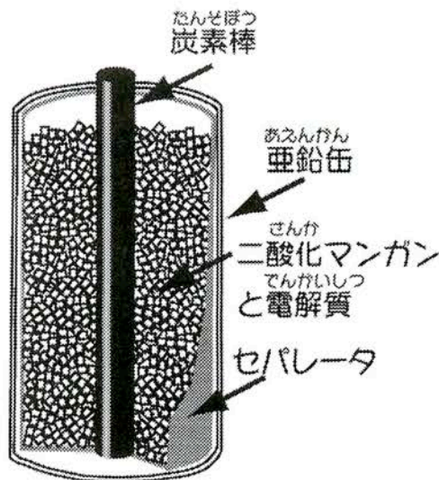
図1 マンガン電池のしくみ
