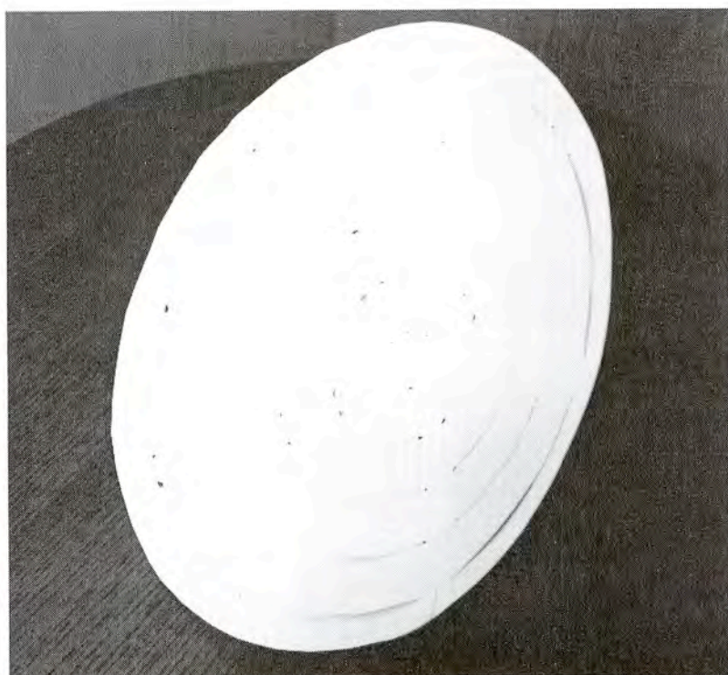
図 円錐形を組み立てたパラボラ鏡
