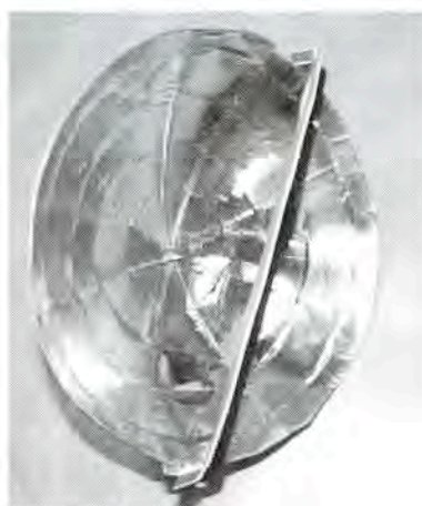
図 焦点にLEDとフォト・トランジスターを取り付けるための橋渡しのボール紙を付けたパラボラ鏡
