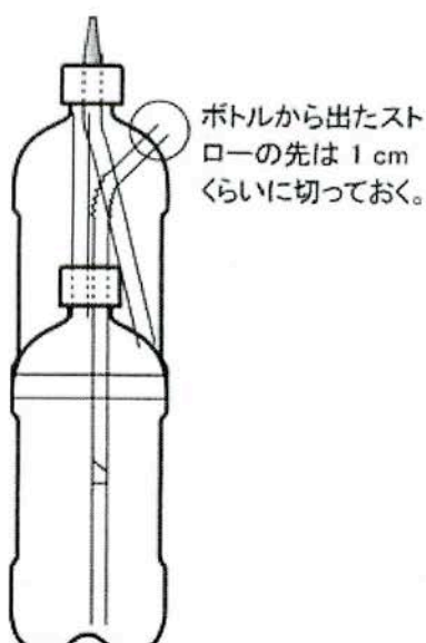
図 9 ストローとキャップの組み立て (2)
