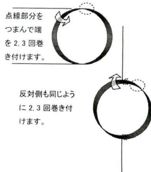
図 4 コイルの両端を固定します。
