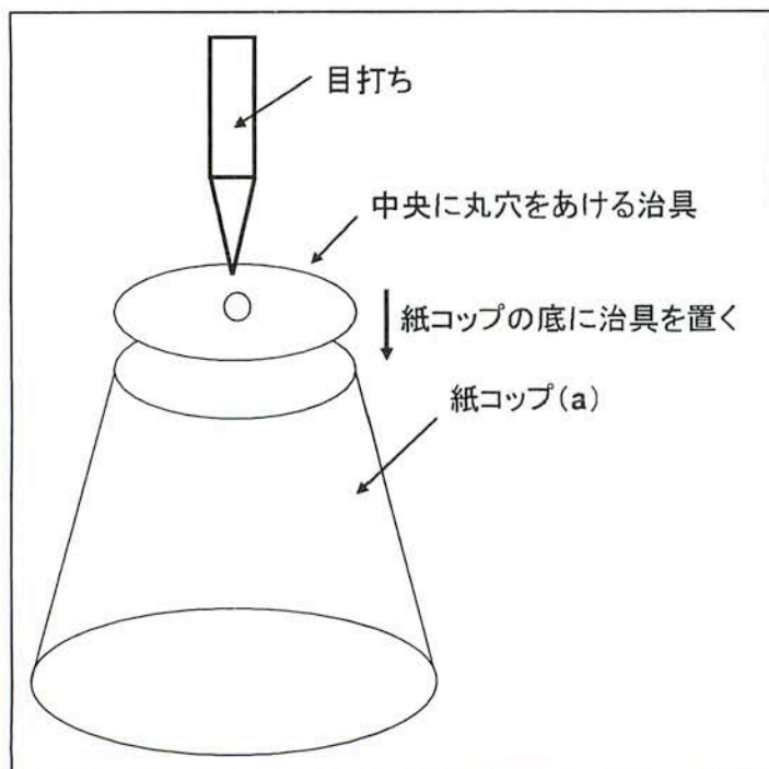
図4 紙コップ (a) の底の中央に治具を使って直径約6mmの丸穴をあける。 (中の黒い紙にもあける)
