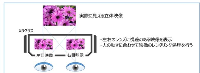
図6 臨場感のあるXR映像の仕組み
