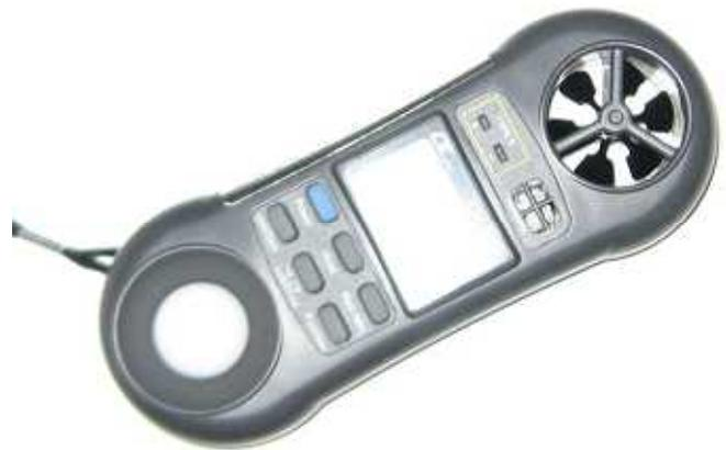
図 9 風速測定器
