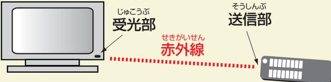
リモコンを操作することで、離れた所からでもスイッチを入れたりチャンネルを変えたりすることができますが、これはテレビとリモコンの間で、赤外線を使った信号の伝送が行われているためです。
