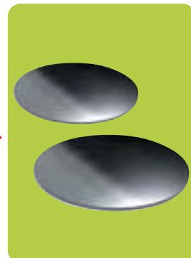
③ その固まりを0.2mmぐらいの薄さに切り、表面をN型半導体に加工します。
