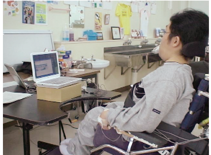
運動機能障害のためにキーボードやマウス操作が困難な人が、筋電インタフェースを使ってパソコン操作しているところです。
